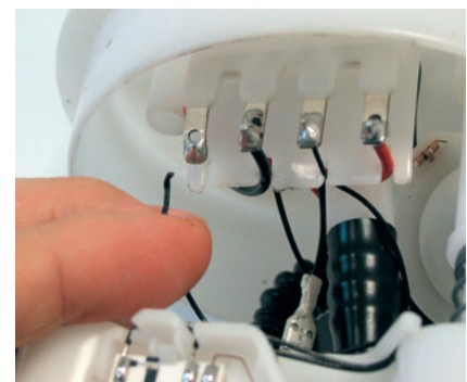
Rys. 3: Typowe objawy uszkodzenia: kabel czujnika poziomu paliwa jest zerwany, styki elektryczne są wygięte.
