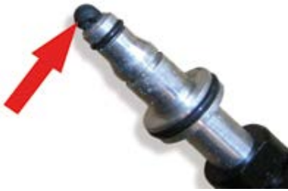
Foto 4: Nieusunięcie starej uszczelki może spowodować zablokowanie płynu do wysprzęglika
