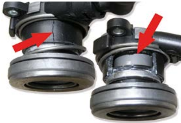
Foto 5: Wysprzęglik zniszczony wskutek nieprawidłowego montażu.
