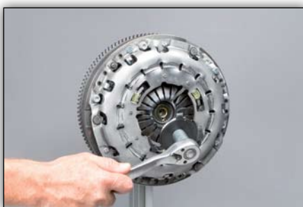
Foto 8: Odkręcić talerzyk blokujący odpowiednim narzędziem i wyjąć. Nie będzie już potrzebny.
