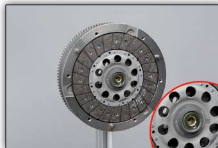
Foto 6: Wykręcić śrubę z tulei centrującej.
