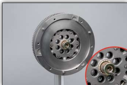
Foto 4: Zamontować tuleję centrującą przed zamontowaniem sprzęgła (uwaga na zamontowaną śrubę)
