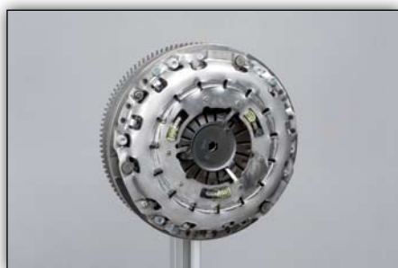
Foto 7: Założyć docisk sprzęgła i dokręcić śruby mocujące momentem zalecanym przez producenta pojazdu
