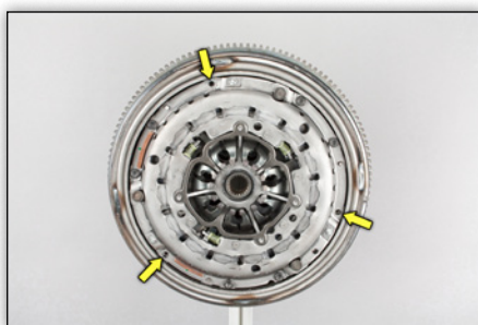
Foto 9: Manualnie wkręcić pozostałe 3 śruby i dokręcić docisk odpowiednim momentem dokręcającym 10,5 \pm 1 Nm
