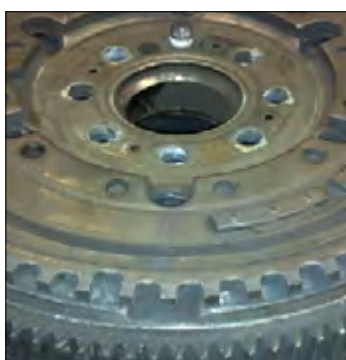
Foto 1: Poprzednia konstrukcja pierścienia czujnika
