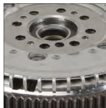
Foto 2: Nowa konstrukcja pierścienia czujnika
