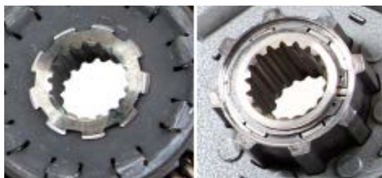
Foto 1: Piasta tarczy LuK (po lewej), piasta tarczy innego dostawcy (po prawej)
