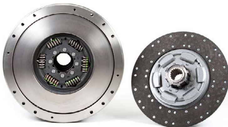
Foto 3: Przykład dwutarczowego sprzęgła z różnymi wielowypustami piasty
