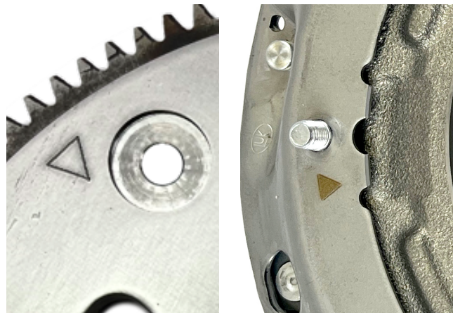
Zdjęcie 2: Oznaczenia na jednomasowym kole zamachowym i podwójnym sprzęgle
