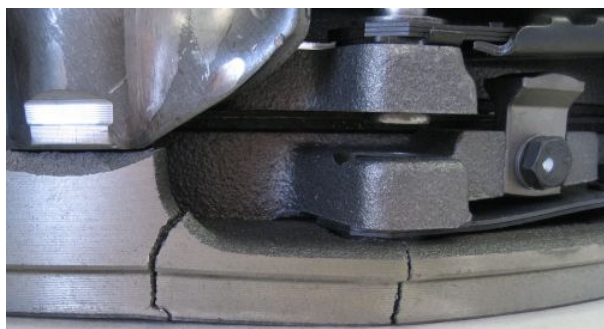
Rys.4 Pęknięcie tarczy dociskowej sprzęgła
