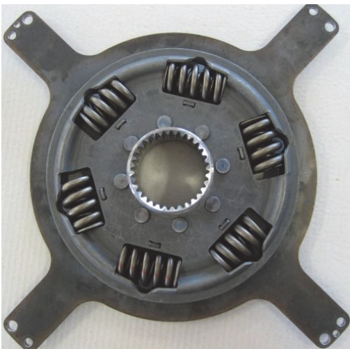
Rys. 2: Tłumik drgań skrętnych przystawki odbioru mocy
