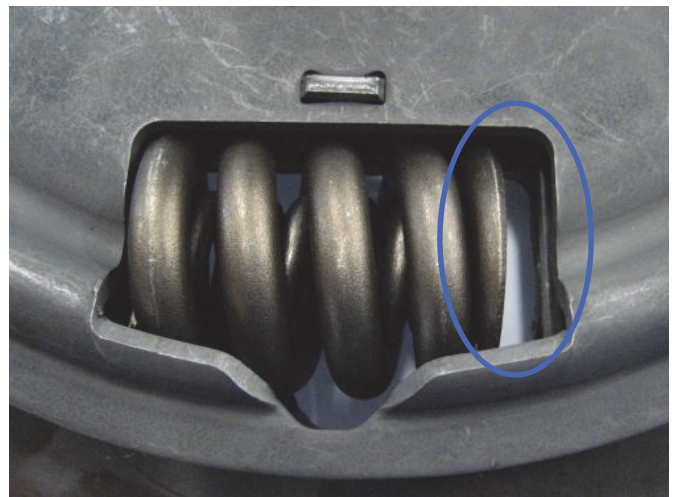
Rys. 3: Sprężyna tłumika z luzem
