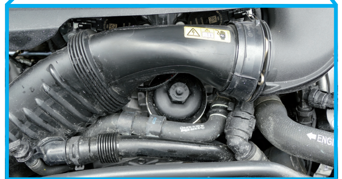
Figure 3 : Position d'installation du filtre à huile dans le compartiment moteur d'une Mercedes C200, moteur M264
