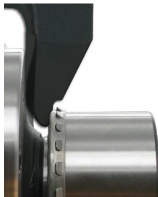
5. Stosuj narzędzie specjalistyczne SKF VKN 600 celem montażu piasty koła.
