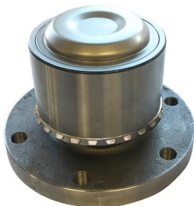
4. Pierścień jest w odpowiedniej pozycji
