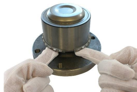
3. Wsuń pierścień na właściwą pozycję.
