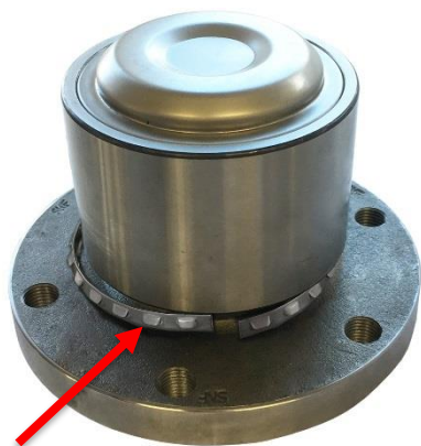
1. Zsunięty pierścień zabezpieczający
