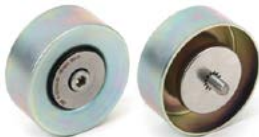
Foto 1: Rolka prowadząca z poprzednim rodzajem uszczelnienia
